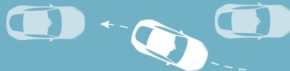
**Le Park Assist** (en option) facilite les manœuvres de stationnement en dirigeant votre véhicule à l'entrée et à la sortie d'un espace adapté. Après avoir sélectionné la marche avant ou arrière, vous n'avez plus qu'à contrôler la vitesse et le freinage du véhicule. Des représentations graphiques et des messages vous guident tout au long de la manœuvre.
