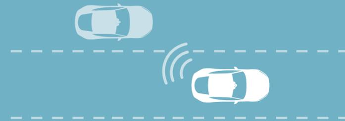
يساعد نظام المساعدة على اكتشاف النقاط العمياء<sup>4</sup> (ميزة اختيارية<sup>10</sup>) في منع التصادمات. إذا اكتشفت سيارتك وجود سيارة أخرى في النقطة العمياء عند بدء تغيير حارة السير، فسيكتشف نظام المساعدة السيارة ويطبّق عزم دوران تصحيحياً لحذرك على توجيه سيارتك بعيداً عن السيارة التي تقترب منك. يستخدم مراقب حركة المرور عند الرجوع للخلف النظام نفسه لتحذيرك عبر شاشة اللمس عند مرور السيارات أثناء الرجوع إلى الخلف.
