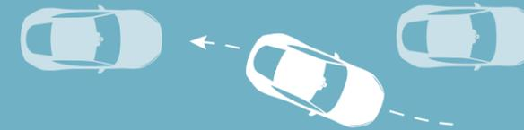
يستطيع مساعد الركن (ميزة اختيارية) أن يسهّل عملية الركن من خلال توجيه سيارتك إلى المكان المناسب ومغادرته. بعد تحديد وضع القيادة أو الرجوع إلى الخلف، ما عليك سوى التحكم بسرعة السيارة وكبحها، وستوجّهك الرسوم والتنبيهات أثناء المناورات.
